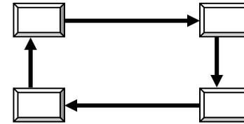
En una red anillo cada instalación está físicamente conectado a exactamente otra dos.
