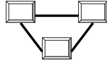
En una red de conexión total cada instalación está enlazada directamente con todas las demás instalaciones del sistema.
