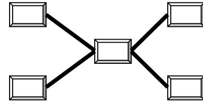
En una red estrella una de las instalaciones del sistema está conectada con todas las demás, ninguna de las otras instalaciones está conectada con otra.
