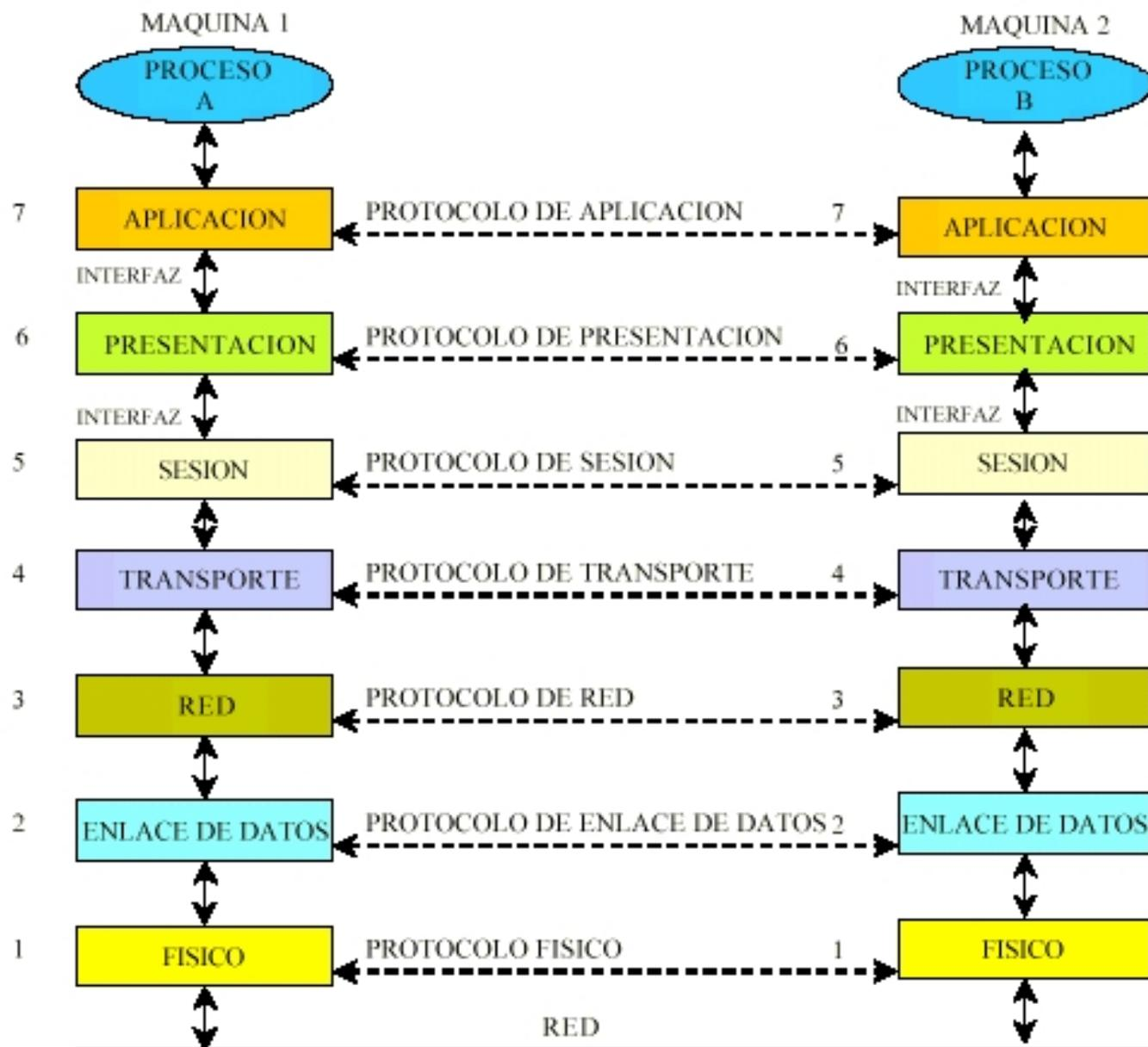
Capas, interfaces y protocolos en el modelo OSI.
