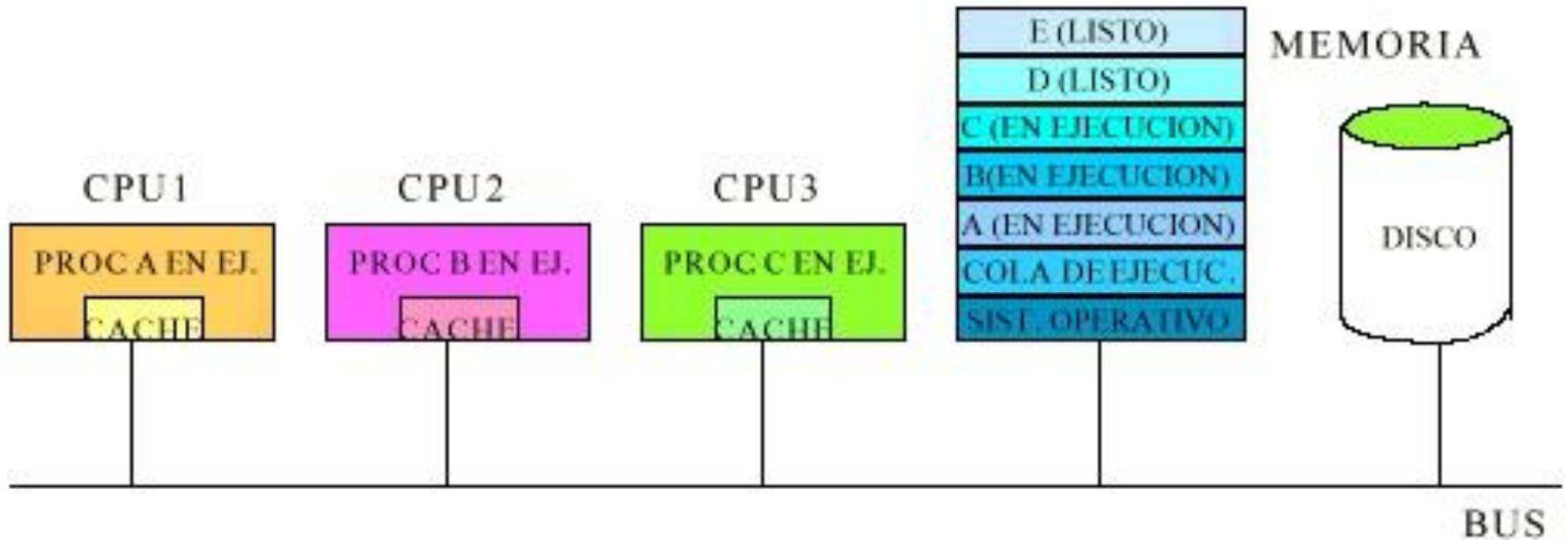
Un multiprocesador con una sola cola de ejecución.
