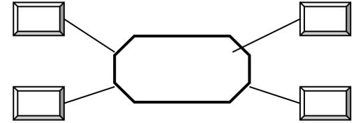
En una red de canal multiacceso existe un solo enlace compartido (el canal). Todas las instalaciones del sistema se conectan directamente a ese enlace que se puede organizar como una línea recta o como un anillo.
